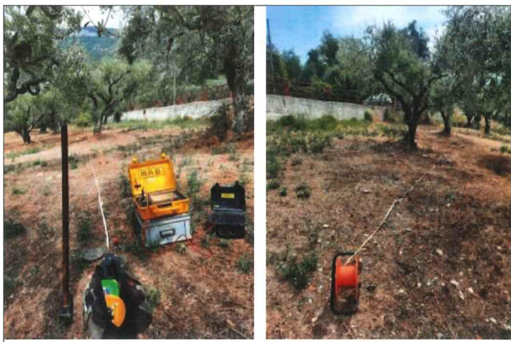
Foto 1 e 2: fase di esecuzione della prospezione sismica M.A.S.W. vista da entrambi i lati dello stendimento.
